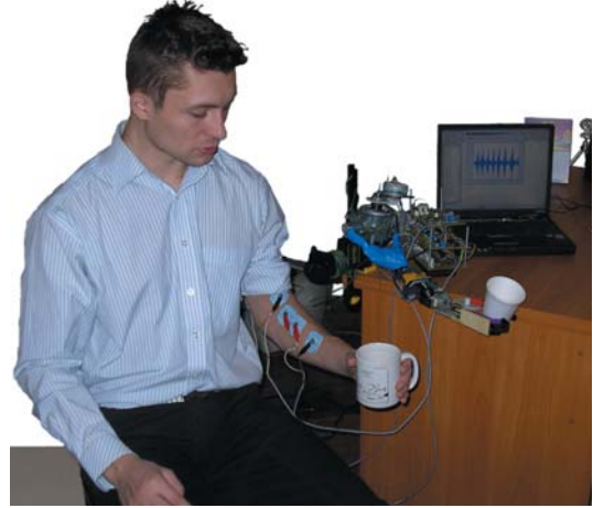
Rys. 7. Wykorzystanie miopotencjałów z trzech różnych mięśni do sterowania manipulatorem ręki
